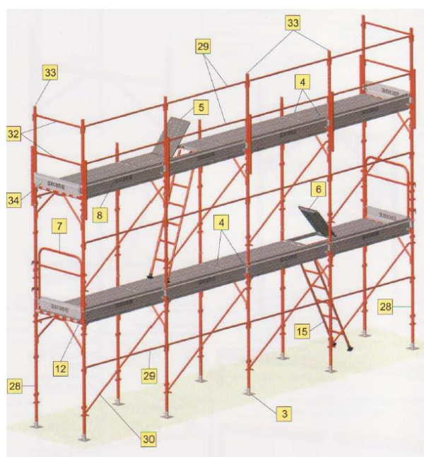
Figura 31 – Esempi di ponteggio a telaio prefabbricato – vista prospettica
