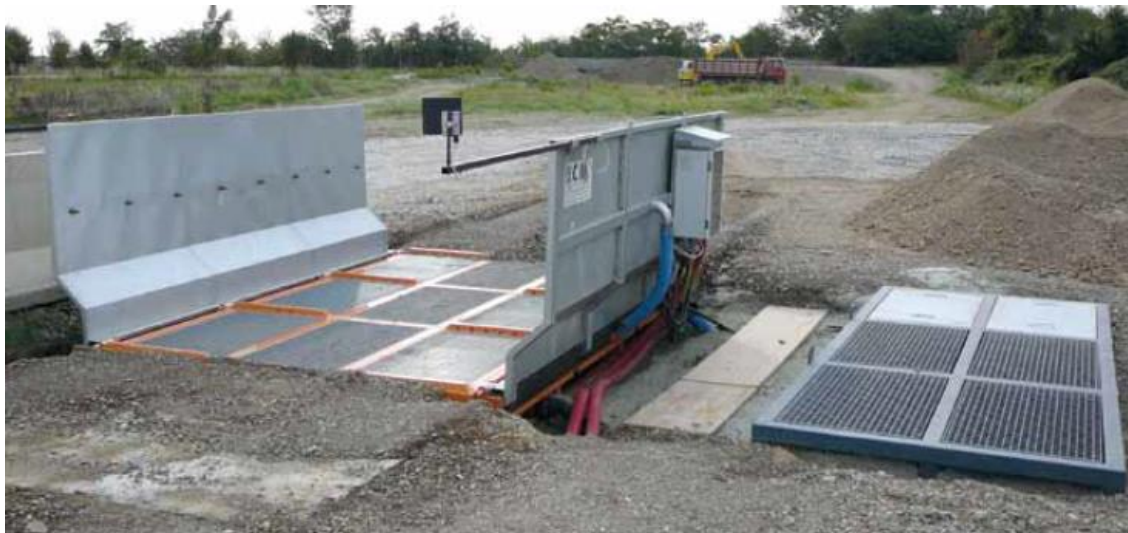
Figura 28 – Esempi di sistema fisso per pulizia idraulica delle ruote dei mezzi d'opera
