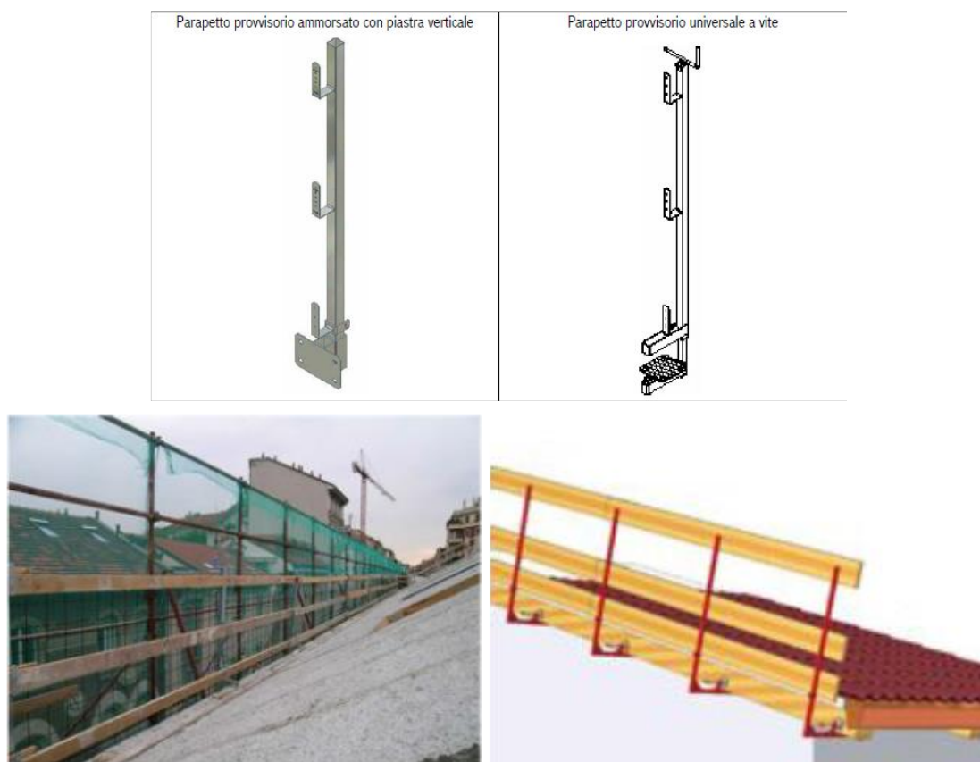
Figura 32 – Esempi di parapetti di protezione in quota
