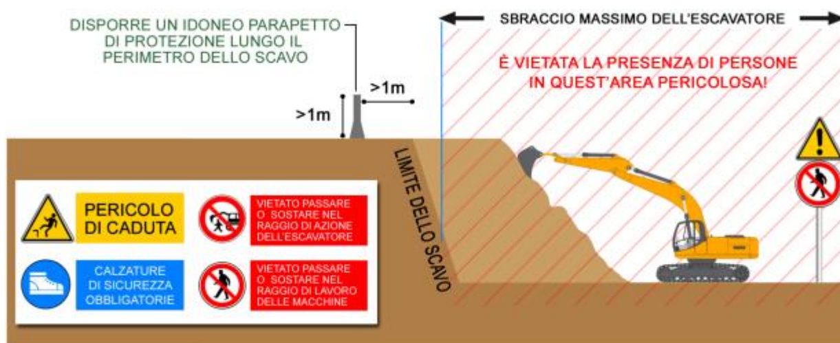
Profilo di scavo a stabilità naturale
